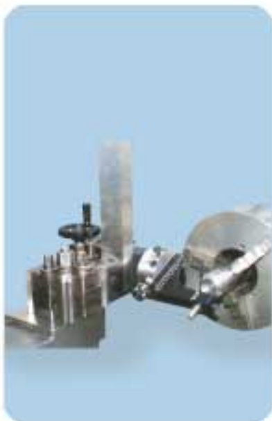
Esecuzione sagoma concava di testa in asse col mandrino
